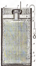
a = Gefäß; b = Zink; e = Depolarisator; d = Innerring; c = Kohlenstift mit Würgeband, f = Hartpech; g = Weichpech; h = Entgasungsraum; i = gelochte, paraffinierte oder gütige Pappeibe; k = poröse Füllmasse; l = Entgasungsrohr
